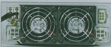
Bild 6: Auf der Rückseite des TS-480HX war offenbar wenig Platz. Die beiden Lüfter verbrauchen die meiste Fläche. So reichte es nur noch für die beiden Stromversorgungsbuchsen (s. Text) und einen Anschluss für ein externes Antennenabstimmgerät, aber nicht mehr für zwei Antennenbuchsen. Sie hängen an Kabelschwänzen heraus.
