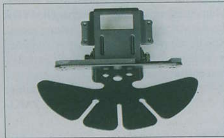
Bild 3: Dieser „Hühnerfuß“ für die Kfz-Montage besteht aus dünnem und unten mit Selbstklebefolie versehenem Blech. Die Lamellen lassen sich der Krümmung des Kfz-Armaturenbretts anpassen. Vier Schrauben ermöglichen zusätzlich einen sicheren Halt. Oben die angeschraubte Halterung für das Bedienteil
