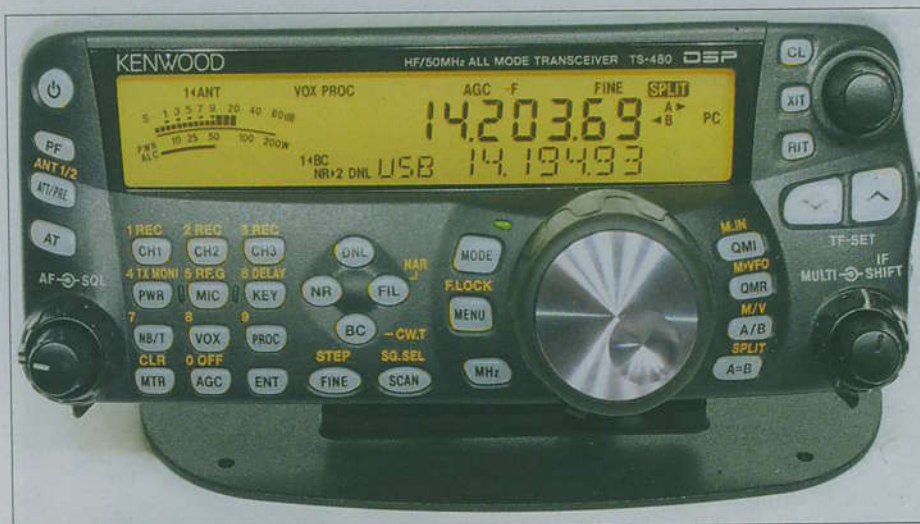
Bild 1: In der Regel dürfte sich beim TS-480 nur das recht kleine und handliche Bedienteil im Gesichtskreis des Nutzers befinden, sodass sich dieses Gerät besonders für beengte Verhältnisse sowie Mobilbetrieb eignet.
