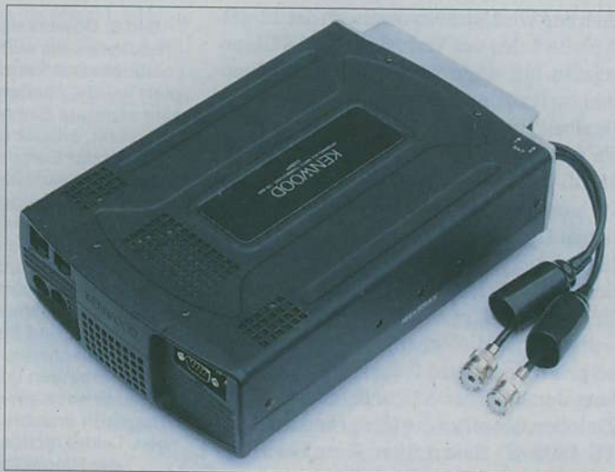
Bild 4: Dies ist der eigentliche Transceiver, den es in zwei Ausführungen gibt: den TS-480SAT mit eingebautem Antennenabstimmgerät sowie 100 W HF-Ausgangsleistung und den TS-480HX stattdessen mit einer zweiten Endstufe und entsprechend 200 W Ausgangsleistung.
